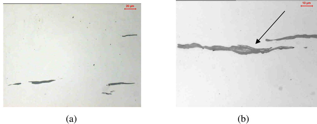
Figura 4.1. (a) e (b) Presença de inclusões no aço estudado. A seta indica a inclusão de sulfeto de manganês (regiões escuras).
