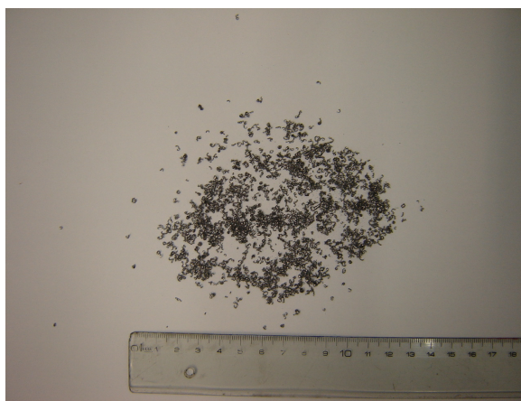
Figura 4.40. Cavaco gerado no torneamento a 10m/min e ferramenta não recoberta.
