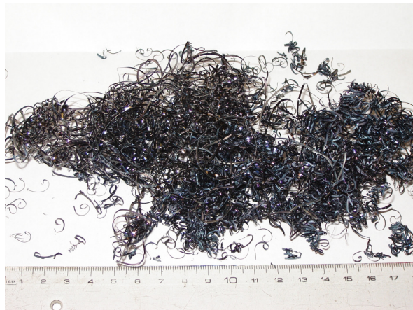
Figura 4.48. Cavaco gerado no torneamento a 300m/min e ferramenta comercial.
