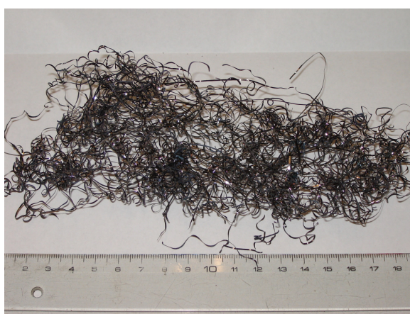
Figura 4.46. Cavaco gerado no torneamento a 300m/min e ferramenta não recoberta.
