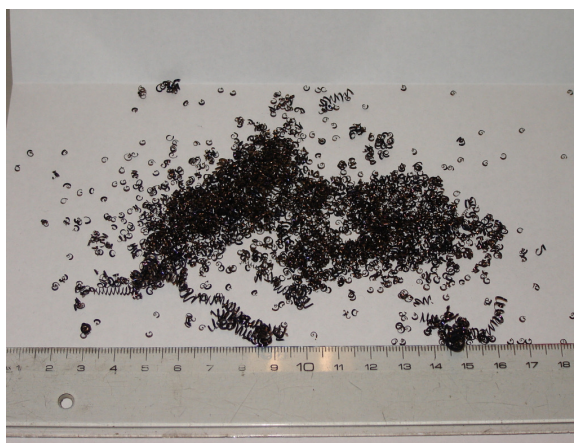
Figura 4.44. Cavaco gerado no torneamento a 100m/min e ferramenta recoberta.
