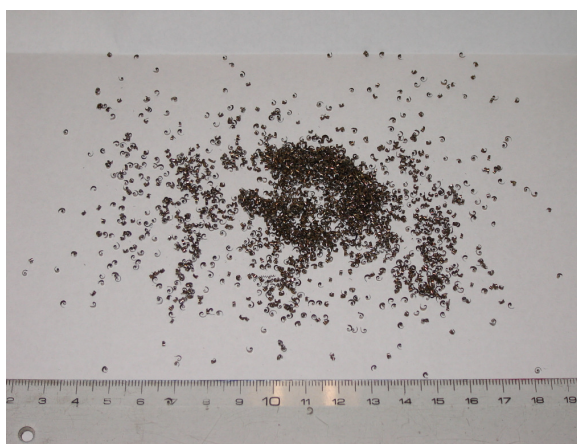
Figura 4.45. Cavaco gerado no torneamento a 100m/min e ferramenta comercial.
