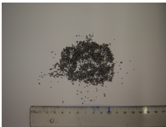
Figura 4.41. Cavaco gerado no torneamento a 10m/min e ferramenta recoberta.
